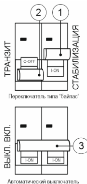
Рисунок 5. Схема коммутации автоматического выключателя и переключателя типа «байпас».
